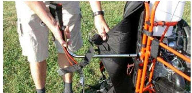
Damit die CB Stangen in der richtgen Position verbleiben, werden sie mittels diesem Bolzen gesichert.
