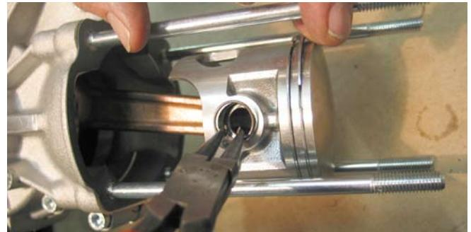
Die Einbaurichtung des Kolbens ist an dem zum Auslass gerichtetem Pfeil zu erkennen.
