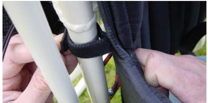
Dieses spezielle Rückenpolster verhindert ein zu starkes Verdrehen des Motors auf dem Rücken des Piloten, welches der Motor durch sein hohes Drehmoment abgibt.
