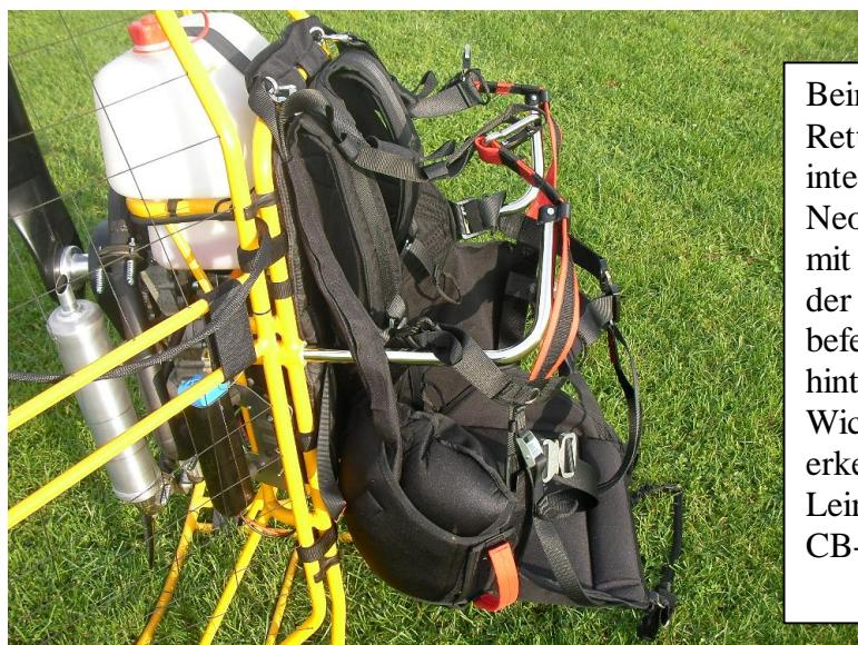
Beim Wingman Cbi ist die Rettung in das Gurtzeug integriert. Der Neoprenaussentcontainer ist mit einem Reißverschluß an der Seite des Gurtzeuges befestigt. Die V-Leine verläuft hinter dem Piloten. Wichtig: Wie im Bild zu erkennen wird der V-Leinentunnel außerhalb der CB-Stange geführt
