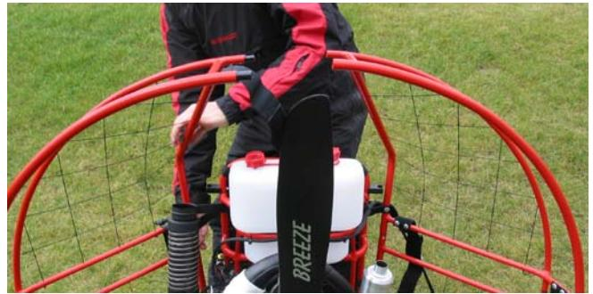
Eine Fixierung wird mit den Klettböndern verhindern unabsichtigtes lösen des Motors von Rahmen.
