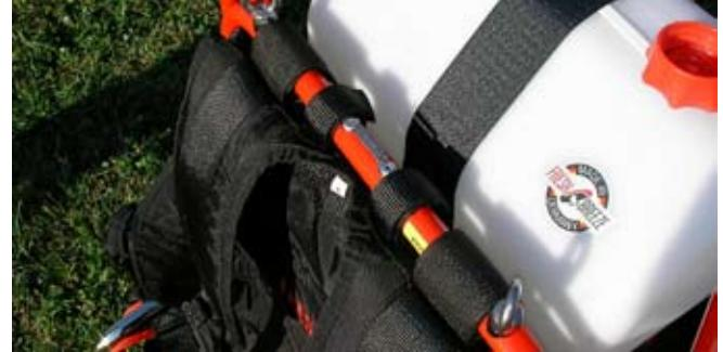
Danach werden Die CB-Stangen in die Aufnahmen vom Rückenrahmen geschoben.
