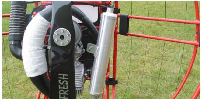
Um den Auspuff beweglich zu halten haben wir verschiedene Befestigungsarten gewählt. Mittels Gummiverbindungen an der Getriebeplatte und federbelasteten Dichtringen an Ein- und Ausgang.
