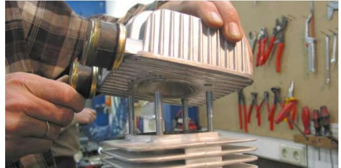
Nachdem der Zylinder von den Stehbolzen gezogen wurde wird der Kolben komplett sichtbar. Um den Kolben von der Pleuelstange zu demontieren müssen zuvor die Sicherungsringe entfernt werden. Nun kann der Kolbenbolzen herausgedrückt werden.
