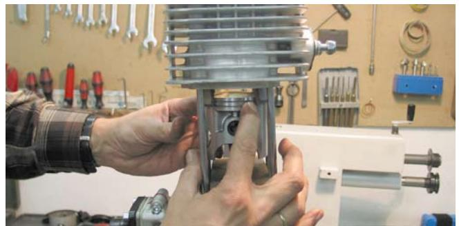
Das Anzugsdrehmoment der Zylinderkopfschrauben beträgt 14 Nm.
