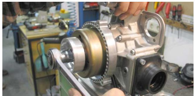
Um den Zündzeitpunkt einzustellen, müssen die beiden Sechskantschrauben der Grundplatte gelöst werden. Die richtige Stellung kann anhand des Bildes ersehen werden.
