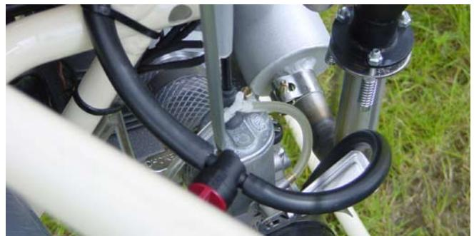
Airboxbefestigung beim Membranvergaser WB
