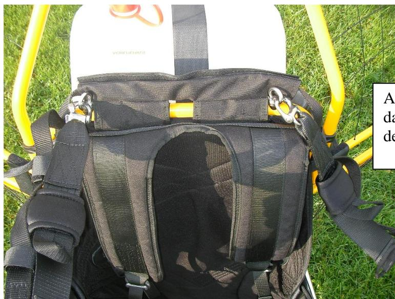
Auch hier zu erkennen, dass die V-Leine hinter dem Piloten verläuft
