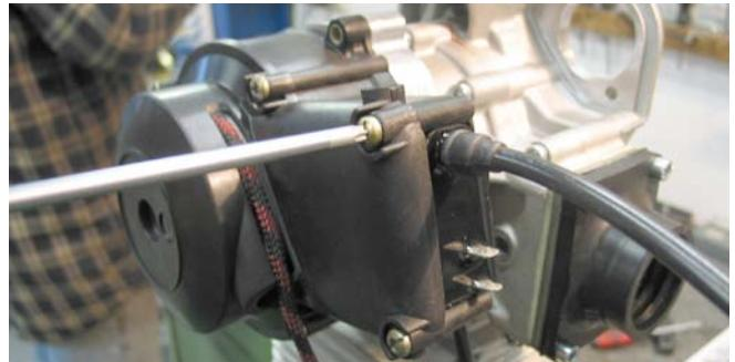
Komplettes Zündergehäuse einschließlich des Starterdeckels demontieren. Nun ist der Rotor mit dem Startertopf sichtbar. Gehalten ist dieser mit seiner Zentralschraube.
