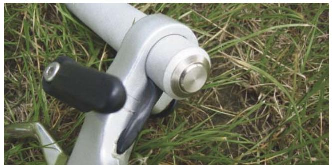
Der Gasgriff verfügt auch über eine Reisegasarretierung. Nach erreichen der Reiseflughöhe kann der Gasgriff über den Klemmhebel festgestellt werden. Da langes Halten des Gashebels in der Hand anstrengend ist, kann er in festgestellter Position auf die Beine gelegt werden. Die Hände sind nun für andere Dinge frei.
